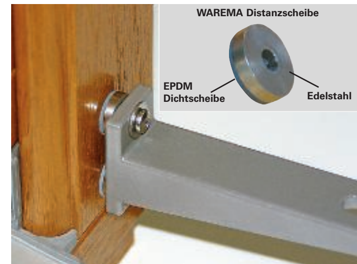
Seilhalter mit Distanzscheibe und Dichtschraube
